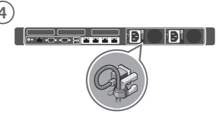
Utwórz pętlę i zabezpiecz kabel zasilania przy użyciu zacisku przytrzymującego.
